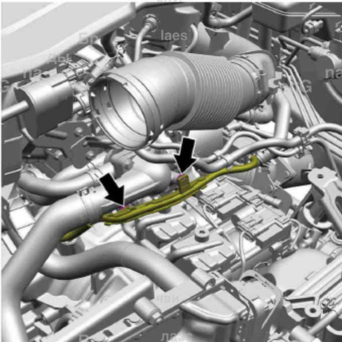
3 Установите 2 крепежных зажима, соединяющих жгут проводов двигателя и компонент т
