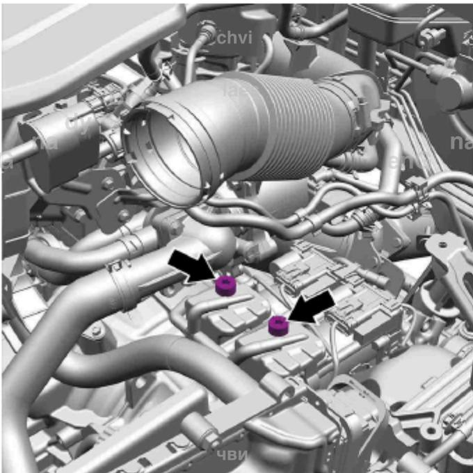
5 Открутите болты маслониливной горловины двух гидростатических фрикционов
